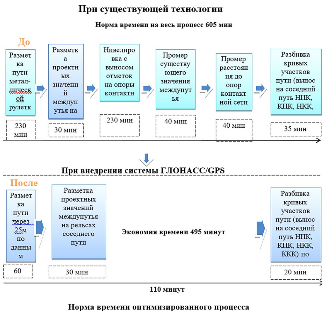
Рис. 6. Оптимизация подготовительно-заключительных операций капитального ремонта пути
