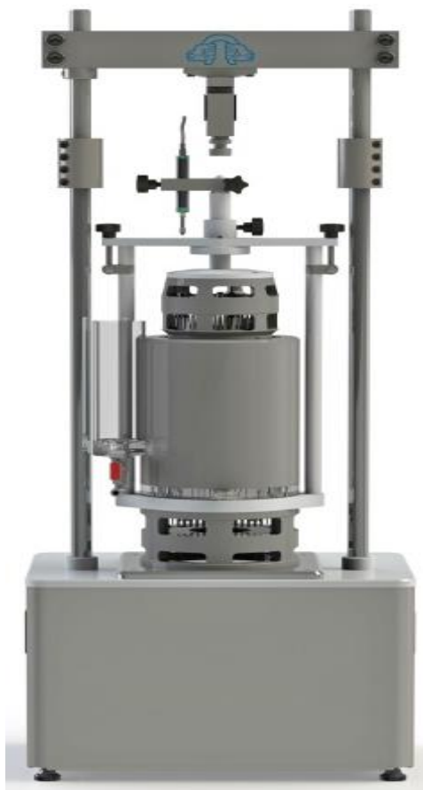
Рис. 3. Прибор ГТ 1.1.8 для определения степени морозного пучения
