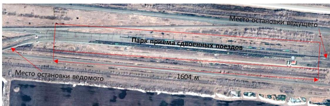
Рис. 7. Место приемки сдвоенных поездов станция Входная
