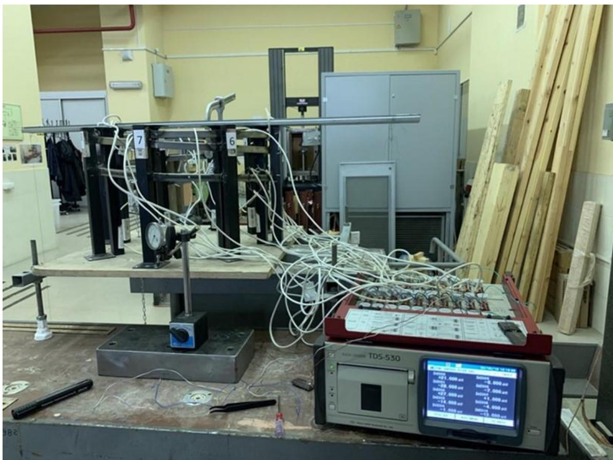
Рис. 6. Испытательная модельная установка для исследования каркаса транспортно-пересадочного узла с кольцевым пандусом, загружаемая весовой нагрузкой, с тензометрическими измерениями напряжений
