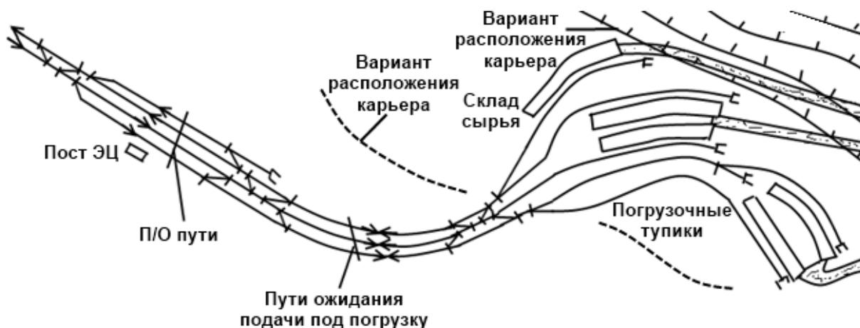
Рис. 6. Схема погрузочной станции
