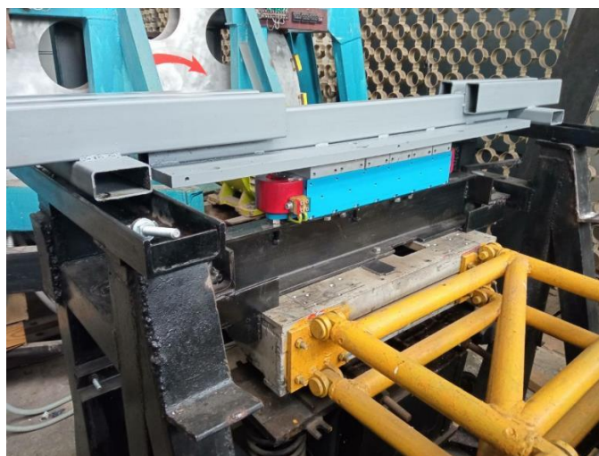
Рис. 2. Гибридный электромагнит на испытательной установке АО ИНЦ «ТЭМП»
