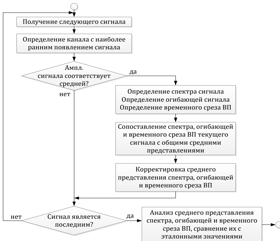
Рис. 6. ГСА обработки сигналов акустических датчиков при выбранном расположении
