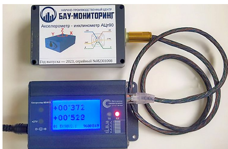
Рис. 3. Акселерометр-инклинометр АЦт90 (вверху). Промышленный сервер-контроллер MS 4812 (внизу)
