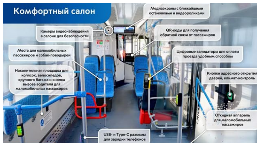
Рис. 2. Наглядные примеры устройств «умного» подвижного состава
