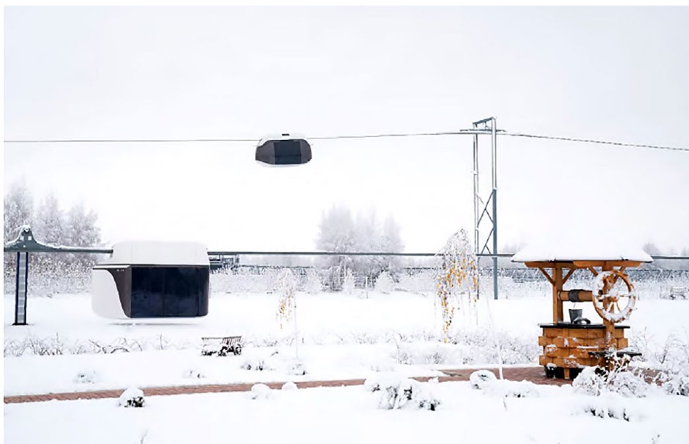
Рис. 3. Струнный транспорт в зимнем ЭкоТехноПарке (на переднем плане – 14-местный юнибус, на втором плане 6-местный юникар). Марьина Горка, Беларусь, 2020 г.
