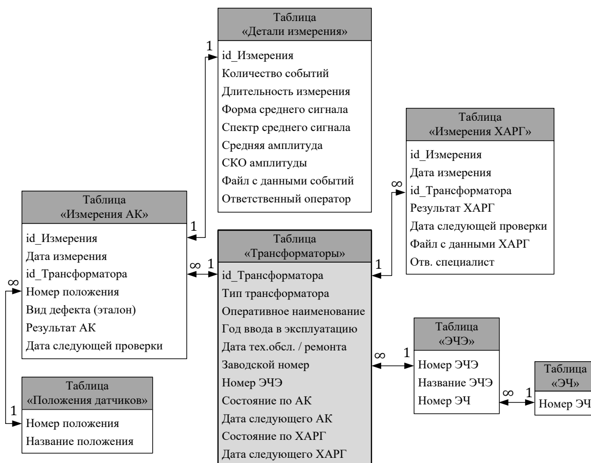
Рис. 1. Предлагаемая структура базы данных АК – акустический контроль; ХАРГ – хроматографический анализ растворенных газов
