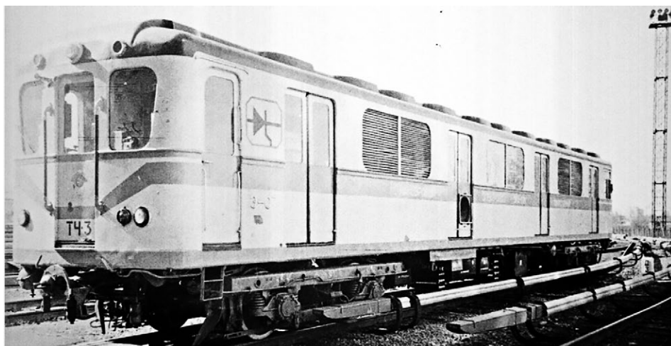
Рис. 3. Контактно – аккумуляторный электровоз Эка-07Т с тиристорным импульсным преобразователем и рекуперативным торможением, созданный на основе вагона «Д»
