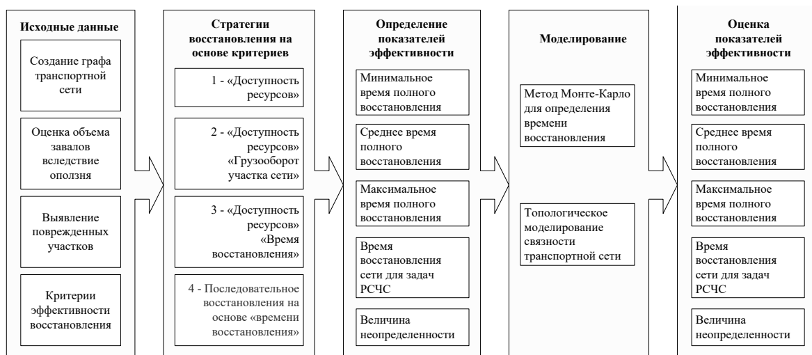
Рис. 2. Структура оценки устойчивости и возможности восстановления транспортных сетей в условиях реализации факторов климатического риска
