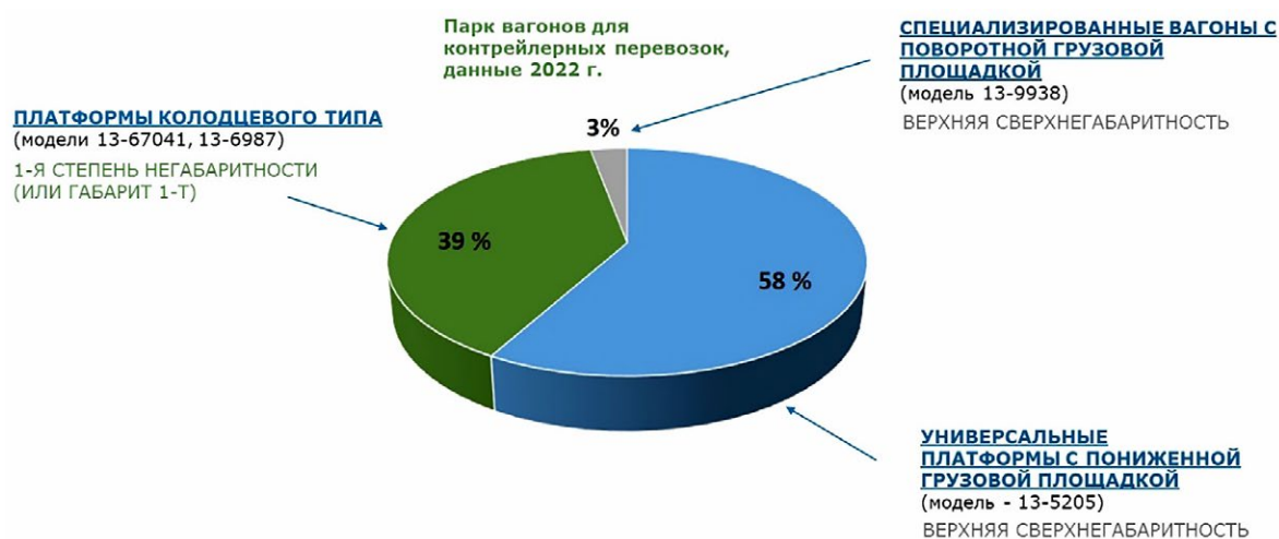
Рис. 2. Классификация железнодорожного подвижного состава, используемого при контрейлерных перевозках по степеням негабаритности погруженных контрейлеров
