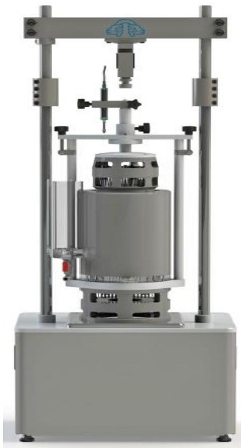
Рис. 3. Прибор ГТ 1.1.8 для определения степени морозного пучения
