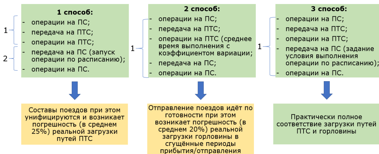
Рис. 2. Способы задания отправления поездов по расписанию при макро моделировании
