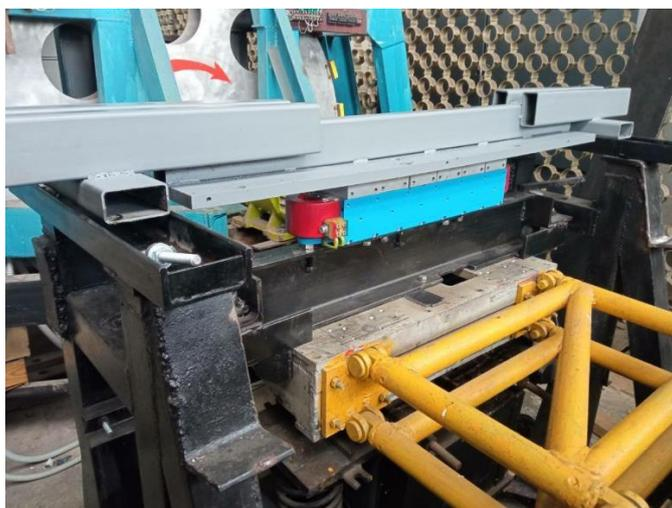
Рис. 2. Гибридный электромагнит на испытательной установке АО ИНЦ «ТЭМП»
